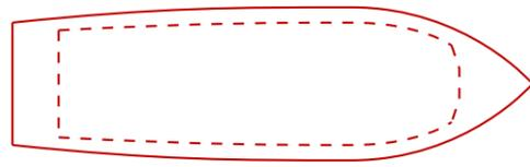
**OFILE DE L'Ô** | *Projet personnel d'habitation à flot sur la base d'un bateau de plaisance fluvial. Longueur : 12m80, largeur : 3m70, tirant d'eau : 1m. Décompartmentation, réhabilitation et aménagements progressifs.*
